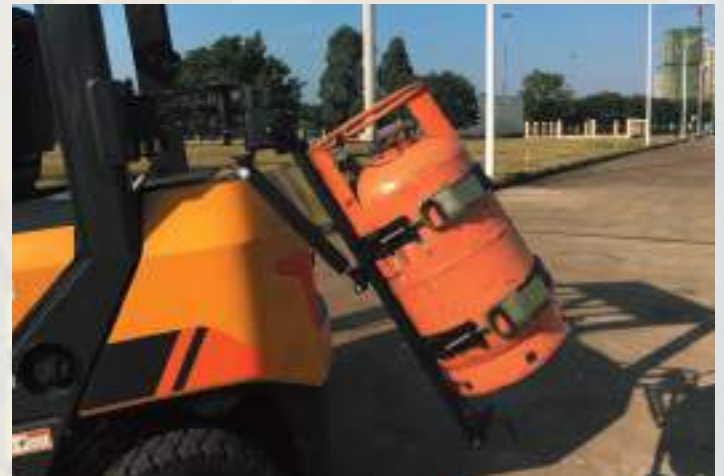
● AÇIK VE KAPALI KONUMDA KİLİTLİ LPG TANKI
